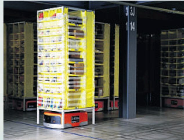
Amazon Robotics maakt platte robots die autonoom kratten door een magazijn rijden. FOTO: REUTERS
